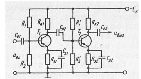
23. Как изменится напряжение на коллекторе  $U_{кнас}$  в схеме каскада в импульсном режиме работы транзистора при увеличении тока базы до  $I_{б6}$
