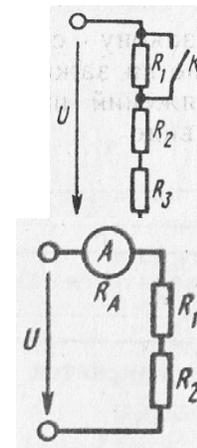
11. Каким должно быть сопротивление амперметра  $R_A$ , чтобы он не влиял на режим работы цепи
