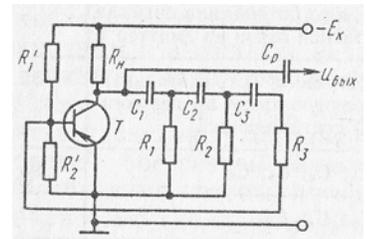
26. В какой из приведенных схем изменение  $\tau_3 = RC$  вызовет изменение периода следования выходных импульсов
