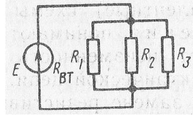
11. Дано:  $R_1 = 10 \text{ Ом}$ ;  $R_2 = 20 \text{ Ом}$ ;  $R_3 = 70 \text{ Ом}$ ;  $U = 100 \text{ В}$ . Сопротивления цепи заменили на  $R_1 = 20 \text{ кОм}$ ;  $R_2 = 40 \text{ кОм}$ ;  $R_3 = 140 \text{ кОм}$  ( $U = \text{const}$ ). Как изменится напряжение на участках цепи
